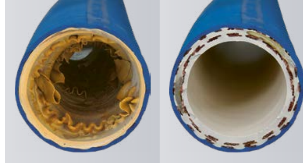
links: Zerstörter Schlauch nach wiederholter Dampfreinigung.
